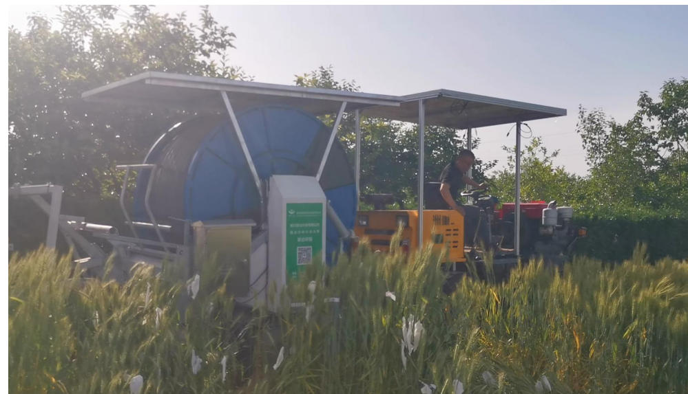
Солнечная дождевальная оросительная машина, Национальная инженерная лаборатория по водосбережению для культур засушливой зоны
