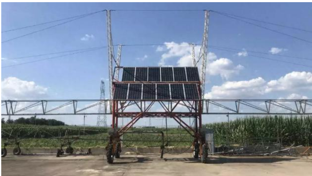
Солнечная дождевальная оросительная машина, Национальная инженерная лаборатория по водосбережению для культур засушливой зоны
