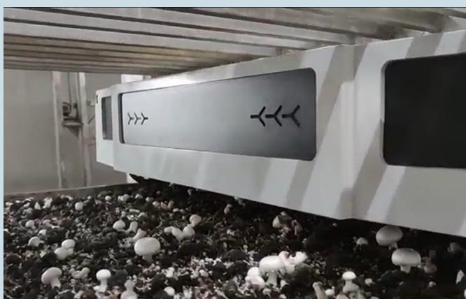
中国农业科学院农业信息研究所青年科学家团队研制的第一代蘑菇智能化采摘机器人。
