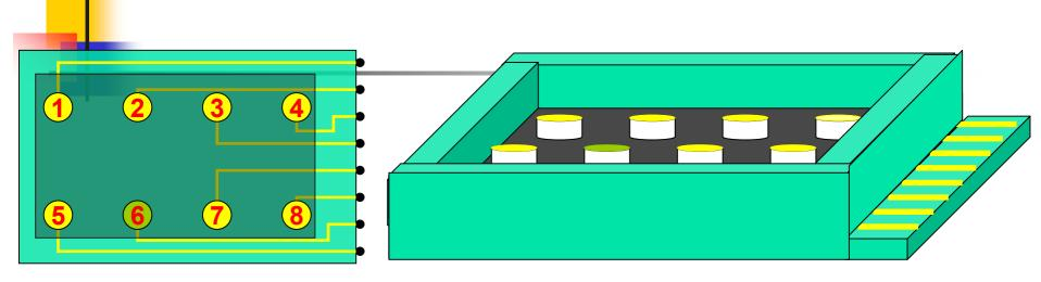
1. NO<sub>3</sub><sup>-</sup>; 2. K<sup>+</sup>; 3. H2PO4-; 4. HPO<sub>4</sub><sup>2-</sup>; 5.PO<sub>4</sub><sup>3-</sup>; 6. Ag/AgCl; 7. NH<sub>3</sub>; 8. pH
