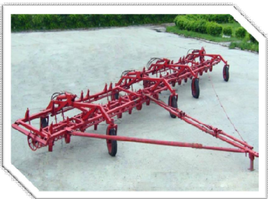
Орудие с ротационными рабочими органами с активным приводом (КФ)
