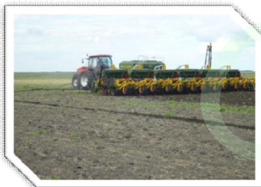
Орудие с ротационными рабочими органами с активным приводом (КФ)
